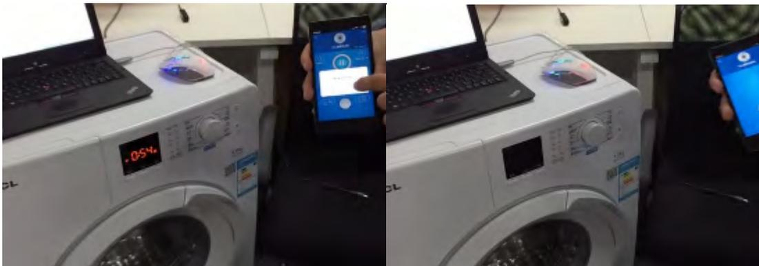
图 4.19 伪造数据包控制洗衣机
