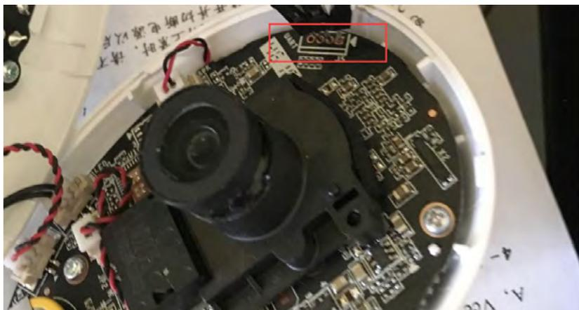
嵌入式开发过程中,为了解决使用 JTAG 调试较大软件效率较低的问题,于是使用 JTAG 接口烧录好启动引导软件(U-Boot)后,便可以使用串口(RS232/RS485)对设备进行调试,提高调试效率。
