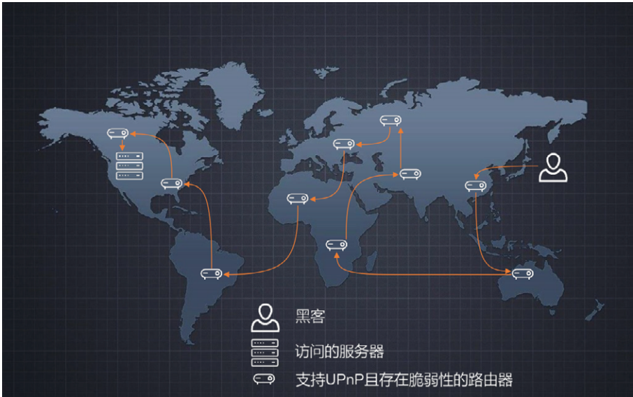
图 4.10 利用路由器 UPnP 服务脆弱性构成代理链的过程
