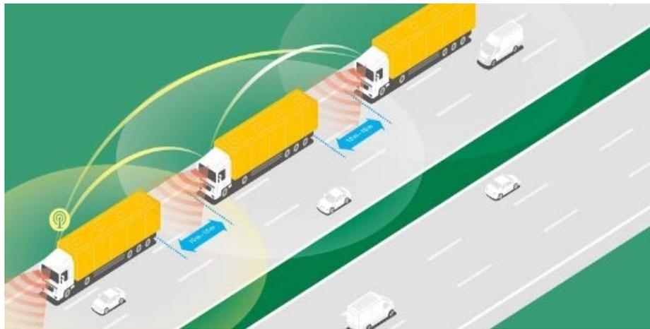
图 13：车辆成队技术的工作原理<sup>13</sup>
