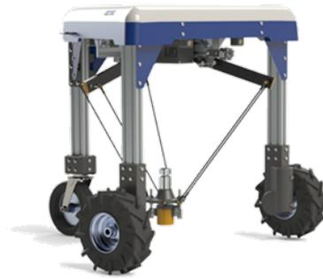
图 3: Odd.Bot 研制的除草机<sup>3</sup>
