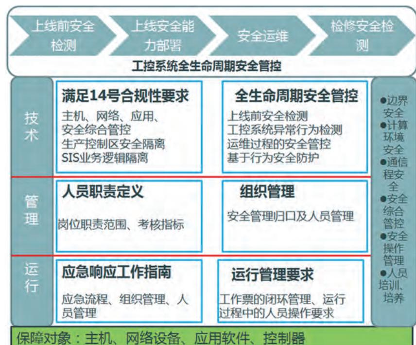
以成熟度、复杂度高的火电为研究对象，参照电力二次系统安全防护的技术成果，遵循国际工控信息安全标准，结合我国工业过程测量、控制和自动化网络与系统信息安全标准，从技术和管理两个层面设计、规划工业控制系统安全防护体系。在满足合规性要求基础上，为了进一步提升工控系统抵御外部威胁的能力，需要从工控系统全生命周期的安全的角度来考虑系统的安全建设，结合业务过程中对安全性的要求及验收规范的要求，通过对系统投运前的安全检测来尽可能的减少系统中潜在的安全隐患。工控系统的特殊性，决定了通信过程的确定性，采用异常检测的手段有效的发现系统中存在的流量过载情况及未知的通信流量，进而发现系统中潜在的异常行为，同时结合在主机终端侧的进程级白名单的机制、通信过程的白名单及业务规程结合，来发现隐藏正常通信和应用过程中的异常通信。
