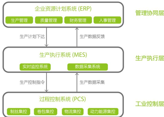
图13 卷烟工业生产应用系统层次结构
