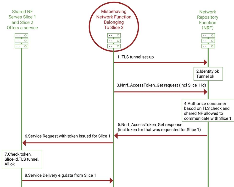
图 3.13 CVD-2021-0047 漏洞利用过程<sup>[1]</sup>
